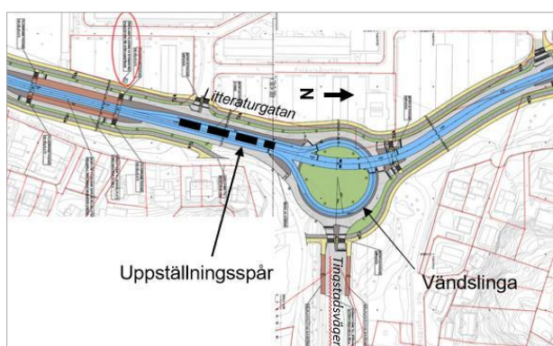
Figur 28. Illustration utformning vändslinga i cirkulationsplats.
