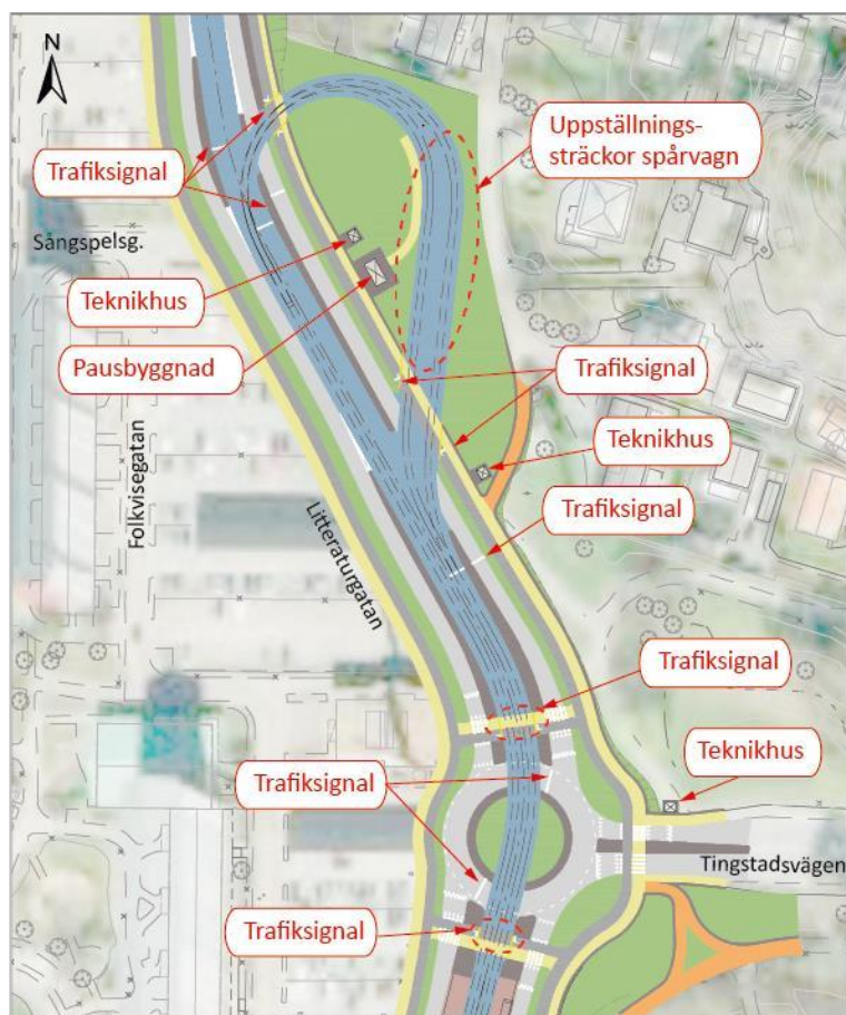
Figur 16. Vändslinga för spårvagn norr om korsningen Litteraturgatan/Tingstadsvägen.
