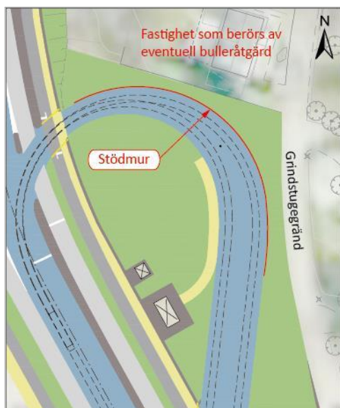
Figur 24. Stödmur mellan vändslinga och Grindstugegränd.
